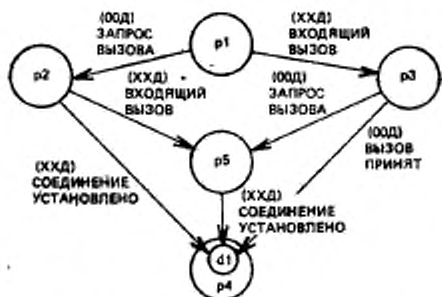
а) Фаза установления соединения
