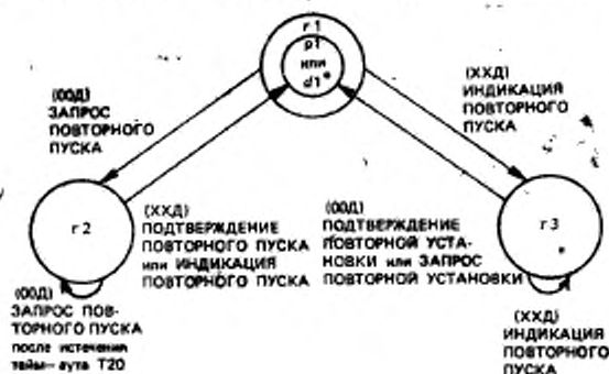
Диаграмма состояний при передаче пакетов повторного пуска
