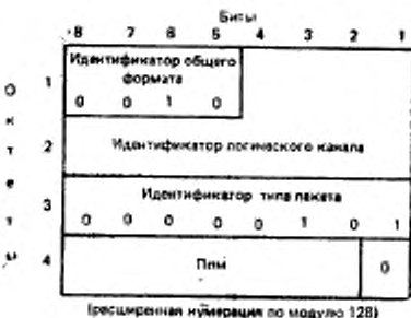
Черт. 19 Формат пакета ЗАПРОС ПОВТОРНОЙ УСТАНОВКИ и ИНДИКАЦИЯ ПОВТОРНОЙ УСТАНОВКИ
