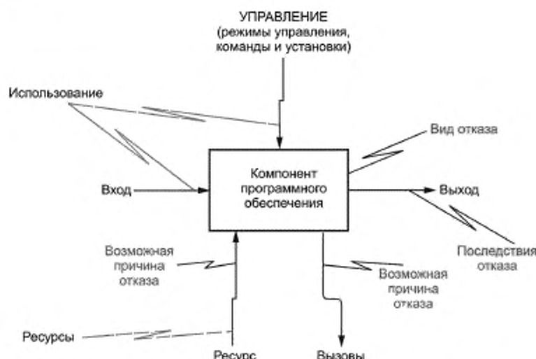
Рисунок Е.1 — Общая модель отказа программного обеспечения для компонента программного обеспечения
