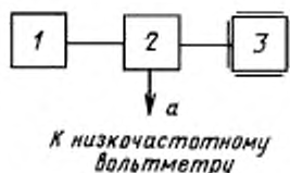
1 — генератор модулирующего сигнала (сигналов); 2 — низкочастотное согласующее переходное устройство 1-го типа; 3 — передатчик
