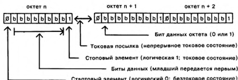
Рисунок 2 — Типичная передача октета при стартстопной передаче
