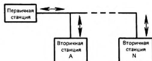
Рисунок 1 — Конфигурация несбалансированного звена данных
