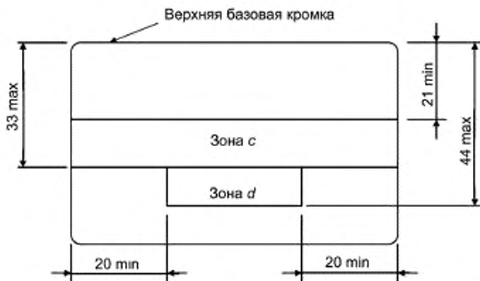
Рисунок 2 — Зоны с ненормируемой непрозрачностью на картах формата ID-1
