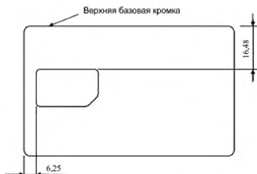
Рисунок В.1 — Расположение карты формата ID-000 относительно карты формата ID-1
