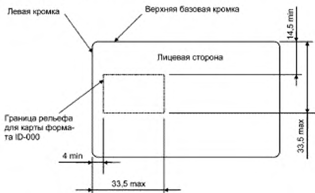
Рисунок В.2 — Граница рельефной зоны
