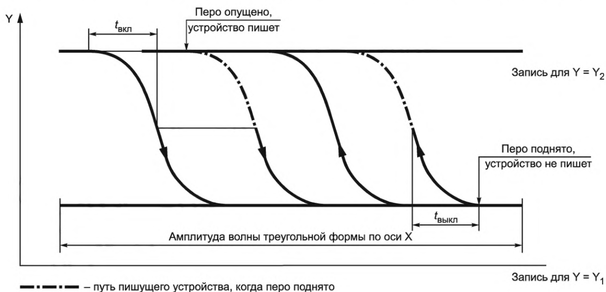
Рисунок 1 — Определение времени задержки для включения и выключения записи
