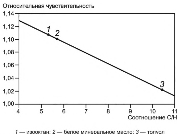
Рисунок 1 — Зависимость относительной чувствительности определения серы от соотношения C/H
