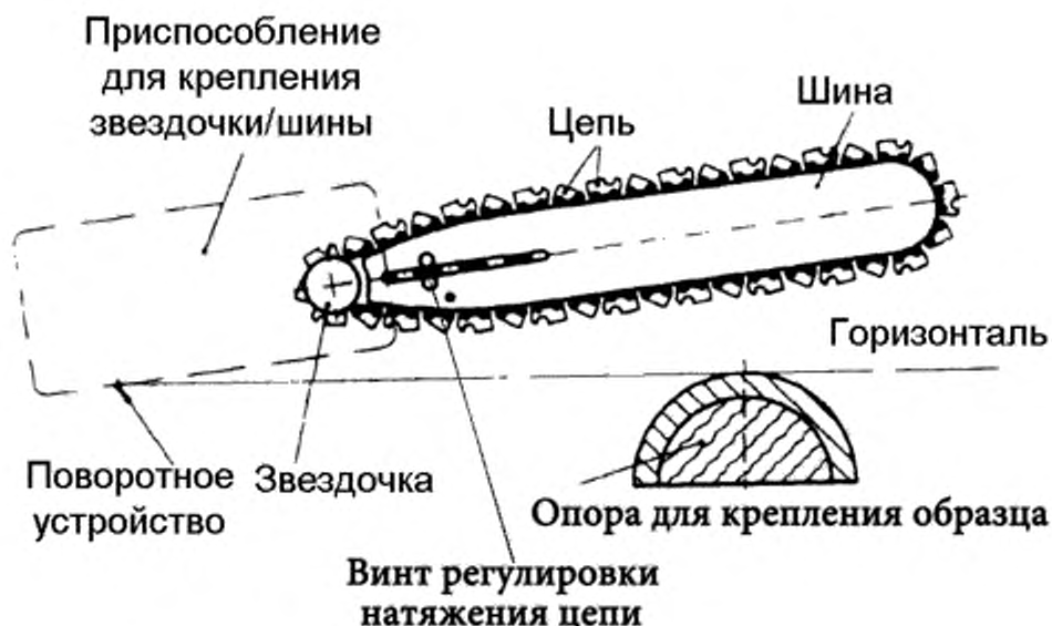
Рисунок 1 – Общее устройство испытательной установки
