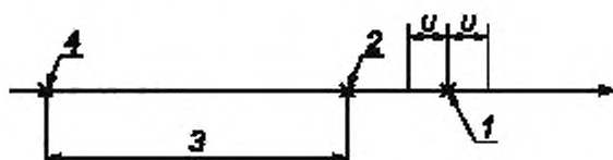
1 — результат измерения; 2 — верхний предел, установленный техническими документами; 3 — интервал, допускаемый техническими документами; 4 — нижний предел, установленный техническими документами
