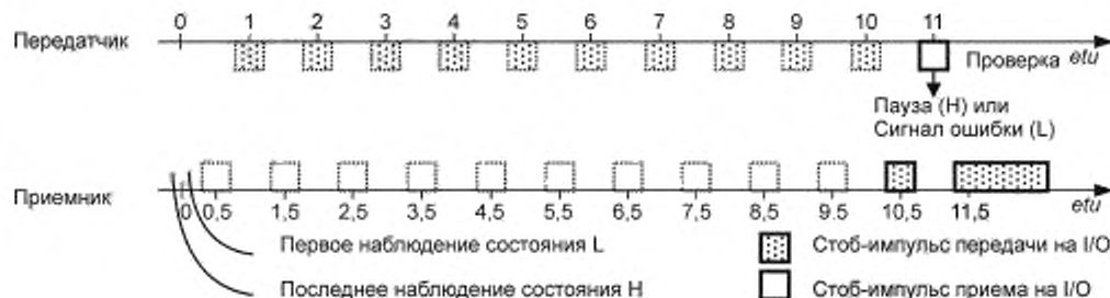
Рисунок 10 — Временные соотношения сигнала ошибки
