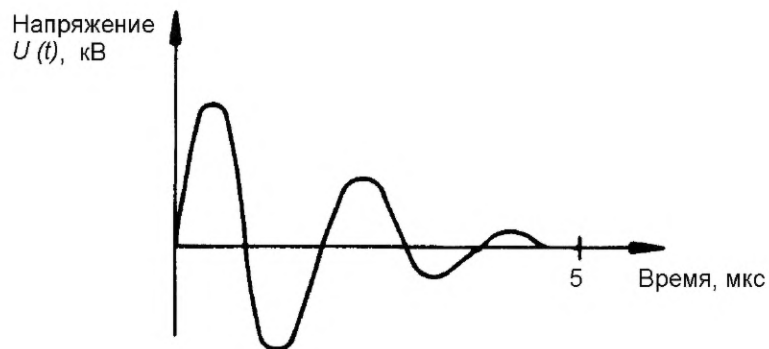
Рисунок S.4 — Форма сигнала при короткозамкнутых ограничителях перенапряжений и изоляции
