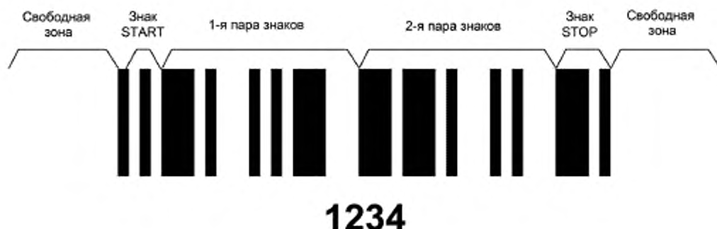
Рисунок 3 — Символ Interleaved 2 of 5, включая свободные зоны
