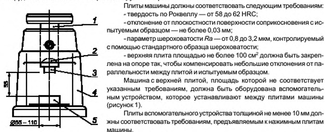
1 — цилиндрический пуансон для передачи нагрузки на образец, 2 — шаровая опора, 3 — верхняя нажимная плита, 4 — жесткая рама, 5 — нижняя нажимная плита
