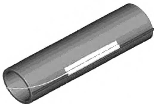
Рисунок 6 — Датчик ограничителя температуры на оболочке электронагревателя
