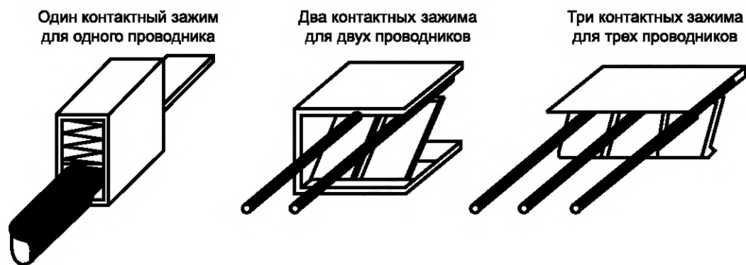
Рисунок F.6 — Примеры безвинтовых контактных зажимов
