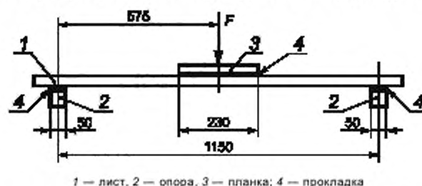
Рисунок 21 — Схема испытания на изгиб целых листов
