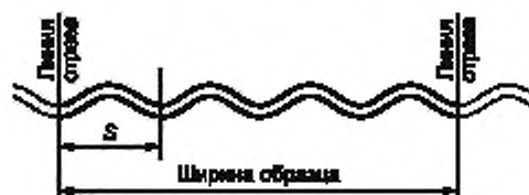
Рисунок 19 — Схема обрезки целых листов перед испытанием
