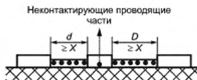
Рисунок F.12 — Измерения через отверстия в кожухе
