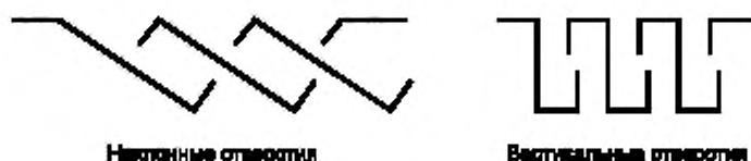
Рисунок 4В — Примеры поперечного сечения конструкции отверстий
