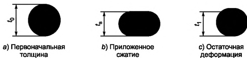
Рисунок 10 — Остаточная деформация при сжатии уплотнительного кольца
