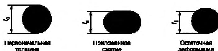
Рисунок 6 — Остаточная деформация при сжатии уплотнительного кольца
