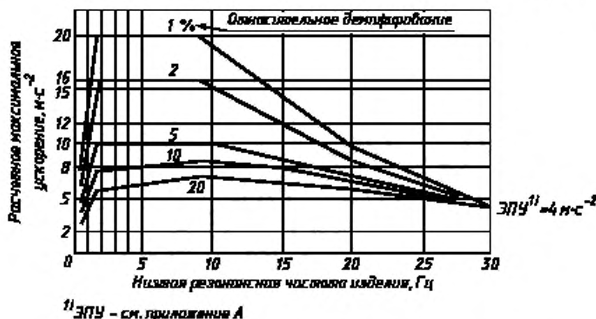
Рисунок 2 — Обобщенные спектры ответа (горизонтальное направление, 9 баллов по MSK — 64 [1])
