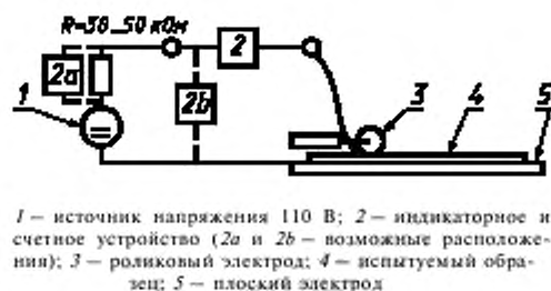
Рисунок 5 — Схема испытательной аппаратуры для определения проводящих включений методом 2
