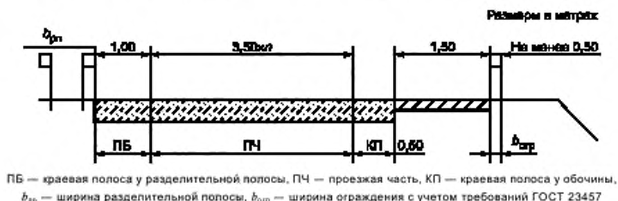
Рисунок 4 — Поперечные профили автомобильных дорог категории II с ограждениями при четырех полосах движения
