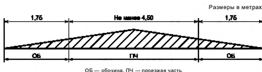
Рисунок 12 — Поперечные профили автомобильных дорог категории V
