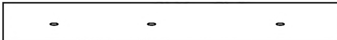
Пример 3 — три несплошности длиной по 3,2 мм
