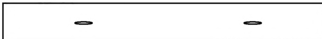
Пример 2 — две несплошности длиной по 6,4 мм
