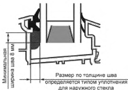
Рисунок 2 — Пример конструкции узла вклейки стеклопакета
