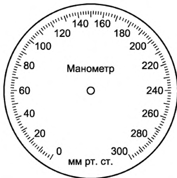
Рисунок 1 — Пример шкалы aneroidного манометра (деление, мм рт. ст., без погрешности в положении нуля, см. 7.1.4.2.3)
