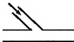
в) Предохранительный клапан ограничения давления (не продутый)
