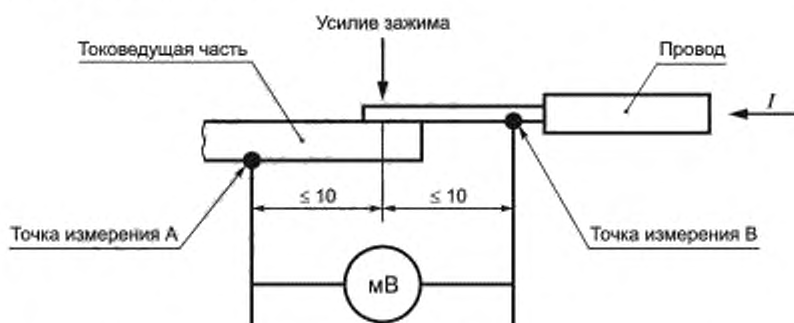
Рисунок 4 — Измерение падения напряжения в точке контакта зажимной клеммы
