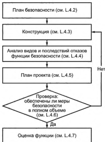
Рисунок L.1 — Процесс проектирования с учетом безопасности
