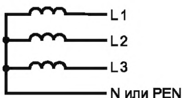
Рисунок 5 – Трехфазная четырехпроводная электрическая цепь
