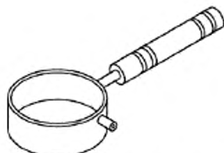
Рисунок 3 — Металлический или керамический ковш с ручкой для розлива воска
