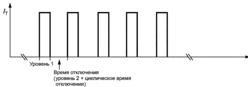
Рисунок F.1 — Профиль испытания тепловой стабильности
