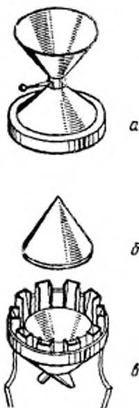
Рисунок 1 — Трехвидовое изображение технического конического сепаратора а — воронка, б — конус; в — перевернутая воронка
