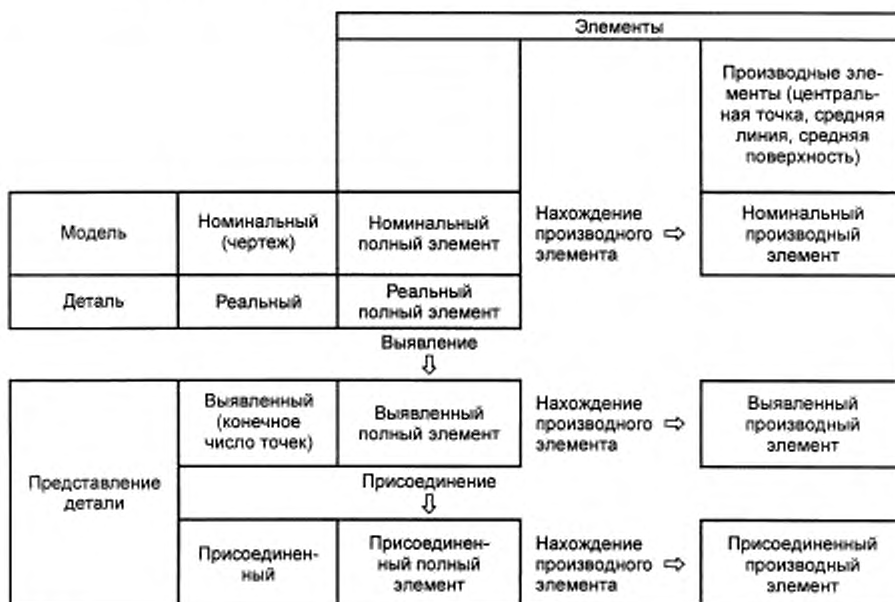
Рисунок 2 — Матричная структура определений геометрических элементов
