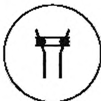
Рисунок Л.2 — Символ маркировки аппарата, содержащего механически связанные контакты
