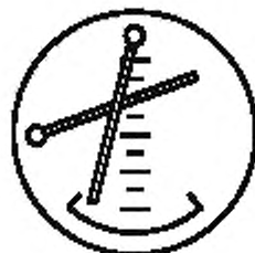
Рисунок 7б — Аналоговый дисплей особенно удобен для объединения нескольких однотипных шкал при одновременном считывании показаний с последующей реакцией. В качестве примера приведен индикатор самолета, одновременно указывающий отклонения от горизонтальной и вертикальной глассад
