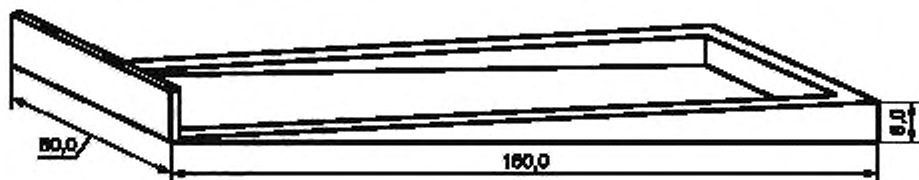
Рисунок 1 — Форма для изготовления образцов при определении стойкости к образованию трещин
