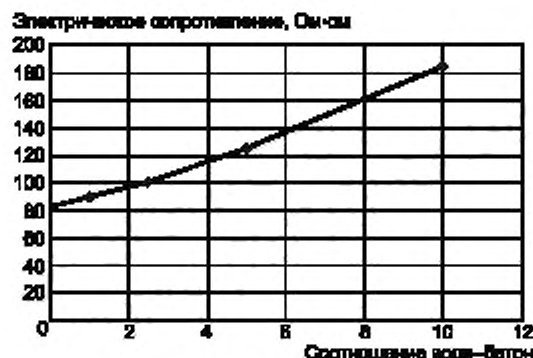
Рисунок 4 — Оценка электрического сопротивления водной вытяжки из бетона
