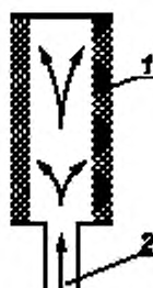
1 — воздухопроницаемый материал (например, из металлокерамики или спеченного гранулированного металла); 2 — газовая среда под высоким давлением
