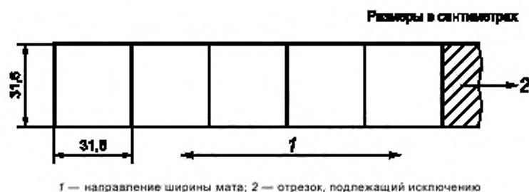
Рисунок 1 — Предлагаемый метод вырезания образцов
