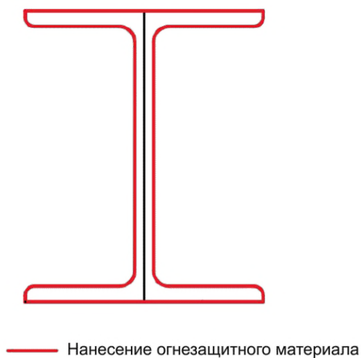
Рисунок Д.2 — Схема двутавровой балки с нанесенным огнезащитным материалом
