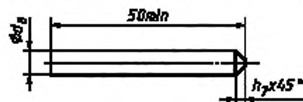
Рисунок 105 — Калибр для проверки фазных гнезд
