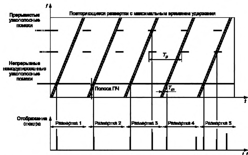
Рисунок 4 — Пример измерения прерывистых узкополосных ИРП с помощью быстрых коротких повторяющихся разверток и функции «фиксации максимума» для получения обзора спектра помехи
