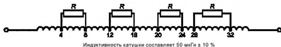
Рисунок А.3 — Схема катушки индуктивности 50 мкГн
