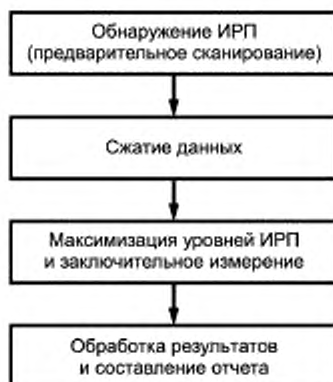
Рисунок 8 — Алгоритм проведения измерений
