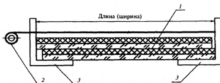
1 — многослойное стекло; 2 — рулетка; 3 — металлический угольник
