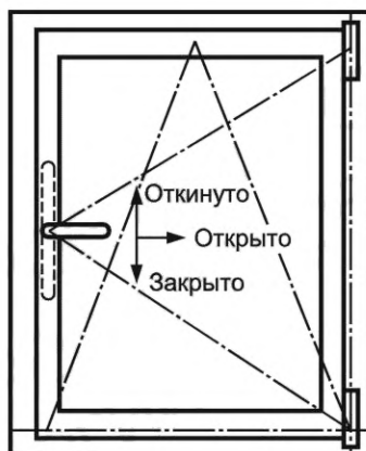
Рисунок Б.3 — Схема поворотно-откидного открывания
