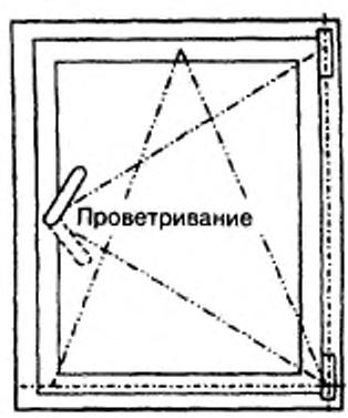
Рисунок А.4 — Устройство по- воротное (откидное, поворотнo- откидное) с функцией регули- руемого проветривания
