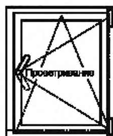
Рисунок А.4 — Поворотное (откидное, поворотнo-откидное) устройство с функцией регулируемого проветривания
