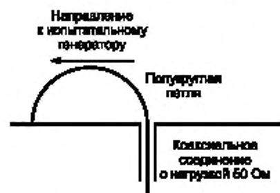
Рисунок D.3 — Полукруглая петля на пластине заземления
