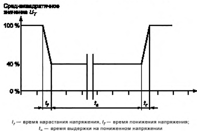
б) Изменение среднеквадратичного значения напряжения (понижение напряжения до 40 % U_T )
